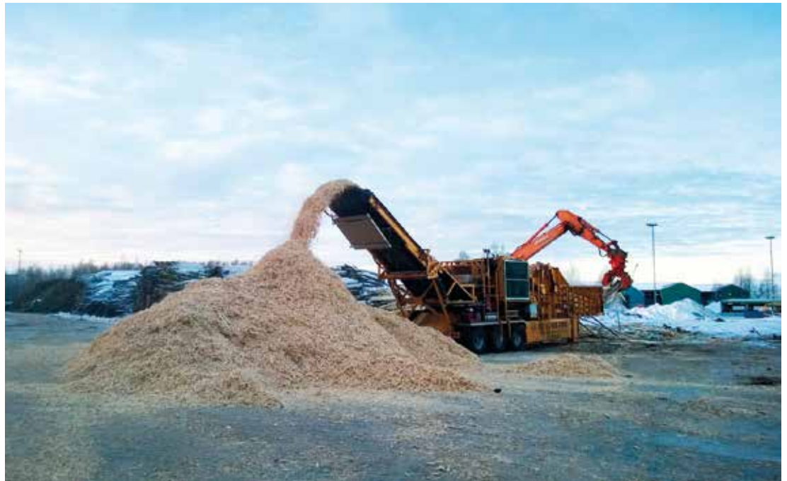
↑ Hakevirran punnitus ja tilavuuden mittaus voidaan tehdä suoraan kuljettimelle asennettavien mittalaitteiden. Metsätehoa ja sen osakkaiden sekä Measurepoliksen yhteistyönä tutkimuksessa kartoitettiin nykyiset bioenergiaraaka-aineen mittausmenetelmät ja -käytännöt sekä tulevaisuuden mittausarpeet niin bioterminaalissa kuin koko hankintalogistiikkaketjun eri vaiheissa.
