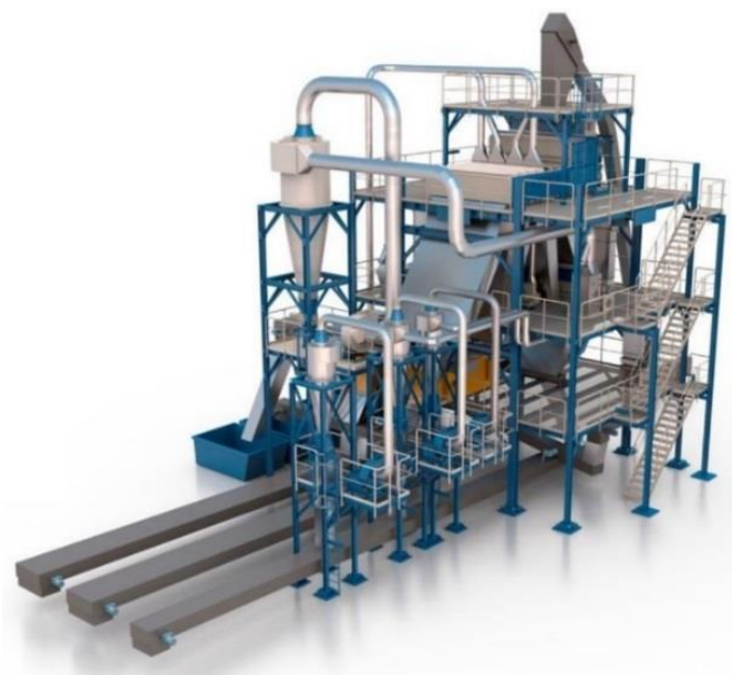
Kuva 15. ClassiCleaner-lajittelu- ja puhdistuslaitteisto (Dieffenbacher GmbH 2015a, s. 2).
