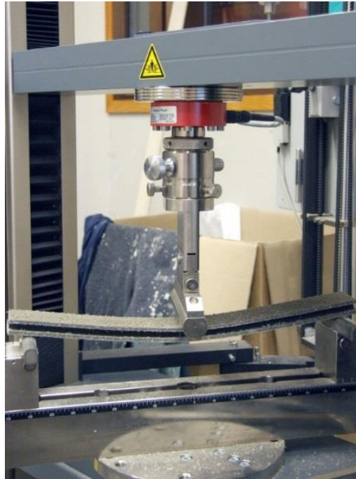
Kuva 27. Tutkimuksessa käytetty Zwick Z020-mittalaite taivutuslujuuden ja taivutusmoduulin määrittämislaitteistolla varustettuna.
