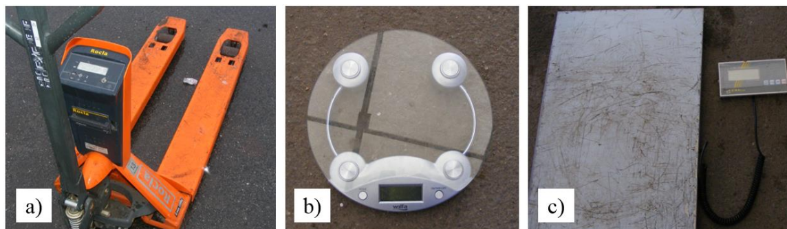
Kuva 11. TSJ:n koostumustutkimuksessa käytetyt vaat: Rocla RHW22 -pumppukärryvaaka (a), Wilfa KW-2 -talousvaaka (b) ja Kern EOB -vaaka (c).
