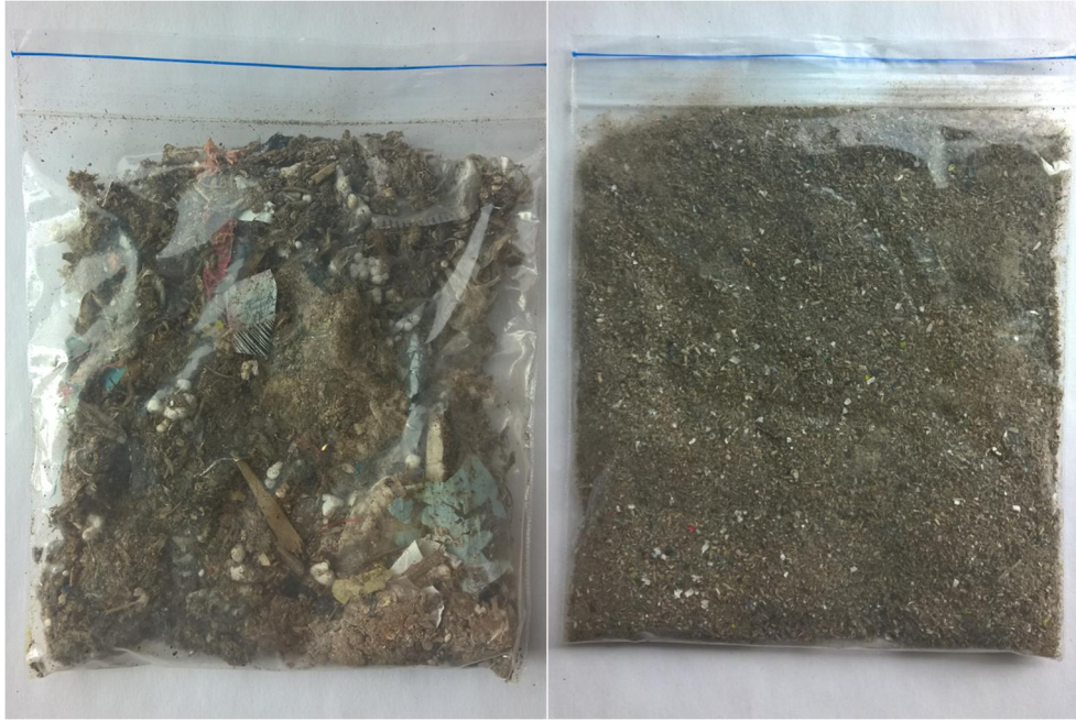
Kuva 6.2. L&T:n Turun kierrätyspolttoaineen tuotantolaitoksen hienoainesrejektiiä karkeana sekä jauhattuna.
