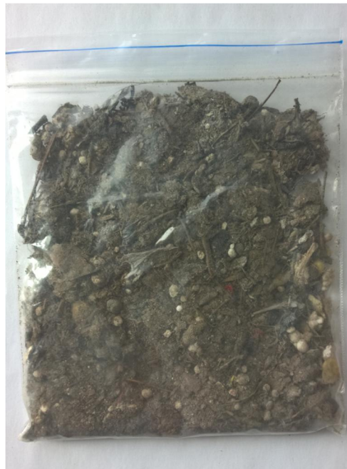
Kuva 6.3. Kuusakoski Oy:n Lahden rakennuskierrätysmateriaalin käsittelylaitoksen hienoainesrejektiiä.
