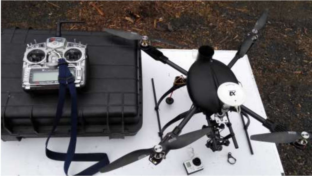
Kuva 3. Lennokki (Flying Drone) ja GoPro HERO 4, joilla hakekasa kuvattiin ylhäältä päin.
