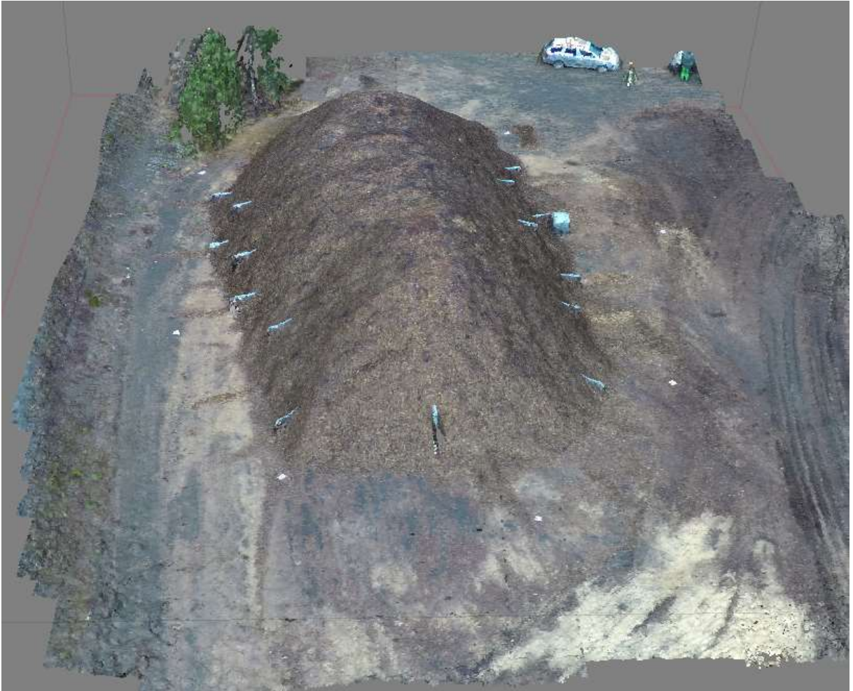
Kuva 7. Lennokilla kuvatusta videosta ja valokuvista muodostettu 3D-malli hakekasasta. (Kuva: LUKE/Jukka Antikainen)
