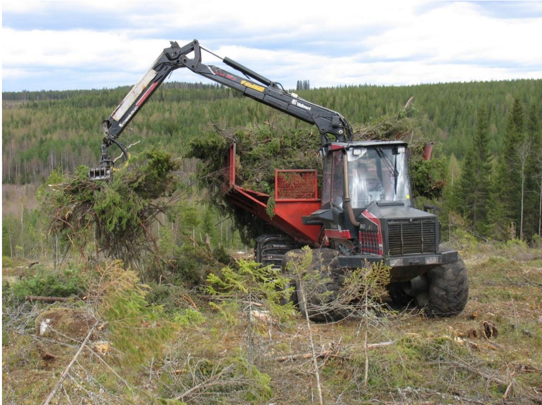
Kuva 3. Hakkuutähteen metsäkuljetusvaihe, jossa metsätraktori on varustettu hakkuutähteen kuljetukseen tarkoitetulla suuremmalla kuormatilalla. (Kuva: Luke/L.Sikanen).
