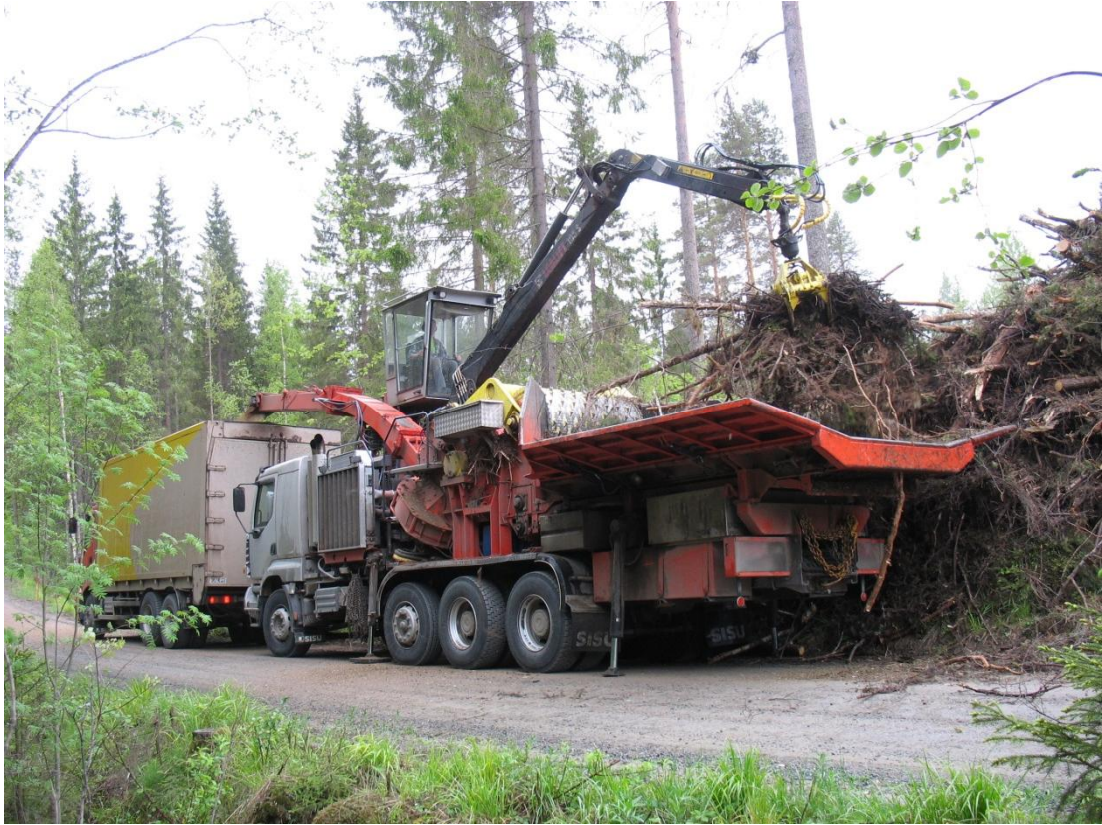
Kuva 5. Hakkuutähteen tienvarsihaketus. Vasemmalla kuvassa pieni laidallisella kuormatilalla varustettu hakeauto ja oikealla hakkurilla varustettu kuorma-auto. (Kuva: Luke/L. Sikanen)
