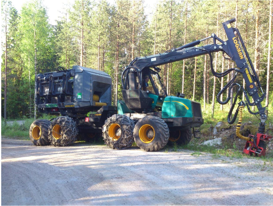
Kuva 15. Testikoneena ollut Logman 811FC ja Fixteri FX15a paalainyksikkö.
