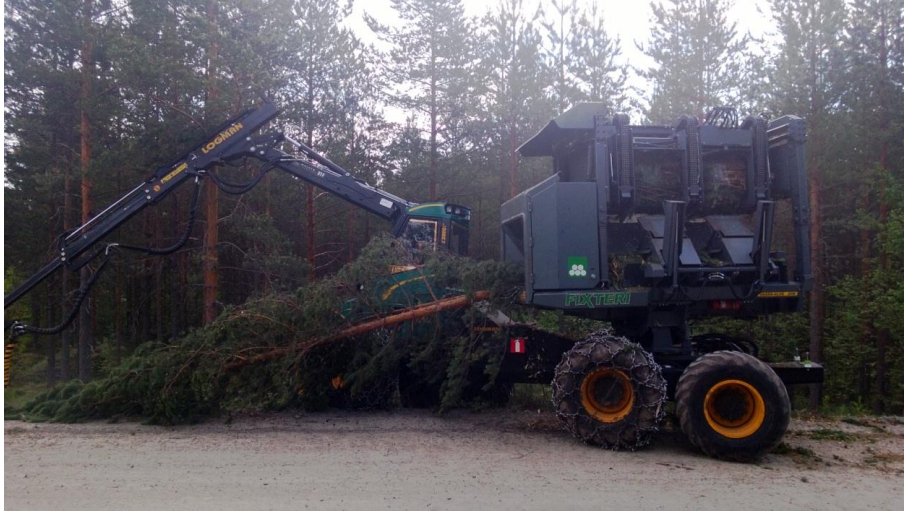
Kuva 17. Kuljettaja keräilee uusia runkoja samaan aikaan, kun paalain syöttää uutta puuta paalaimen alakammioon. Yläkammiosta on juuri valmistumassa sidottu paali ja punnitusvarret ovat laskeutumassa alas.
