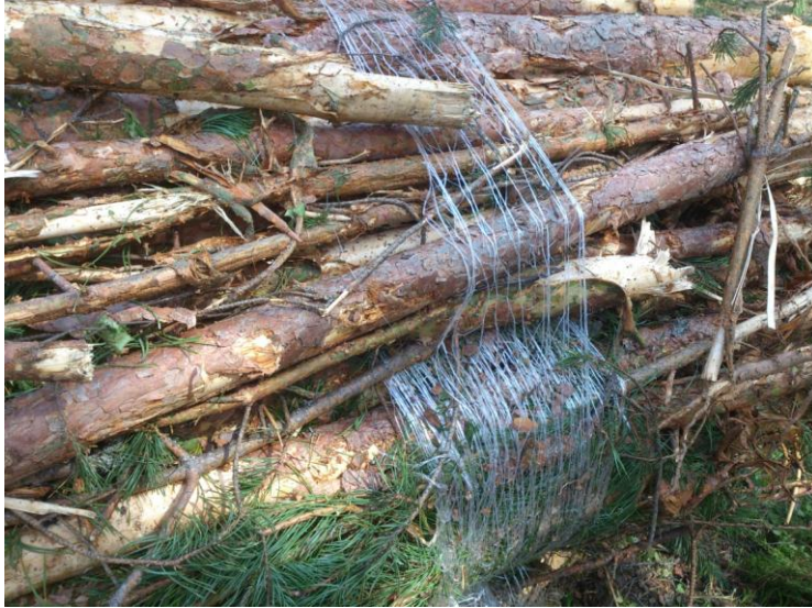
Kuva 53. Sidontaverkkoa ei ole kierretty riittävästi valmiin paalin ympärille. Tämän seurauksena monet paaleista hajosivat metsäkuljetuksen yhteydessä.
