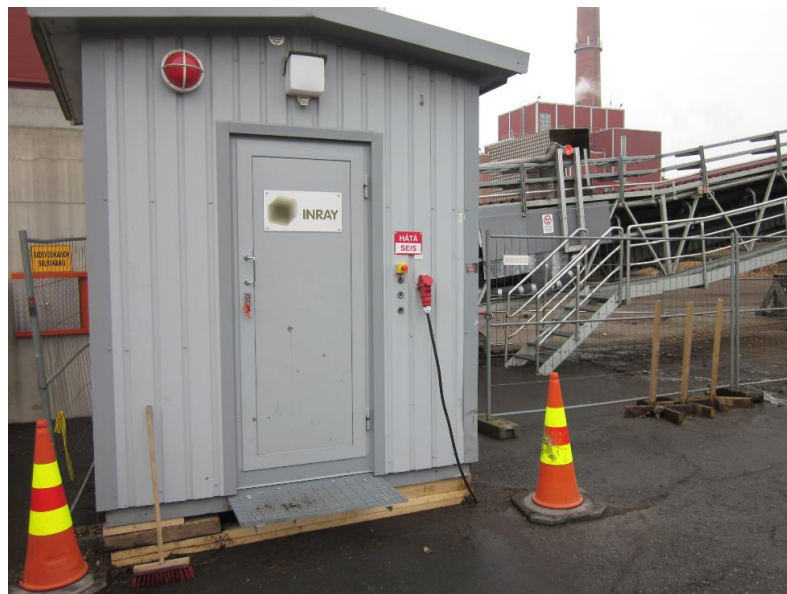
Kuva 6. Kaipolan murskaimen yhteydessä oleva röntgenmittaus laite (INRAY), jolla kantopuun kosteutta ja epäpuhtauksien osuutta myös mitattiin.
