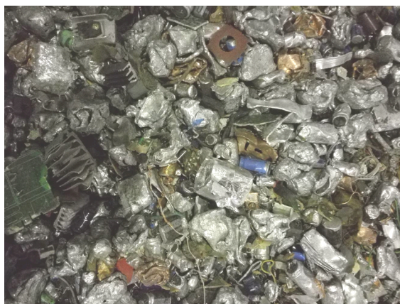
Kuva 13: Pyörrevirtaseparaattorilla separoituja partikkeleja
