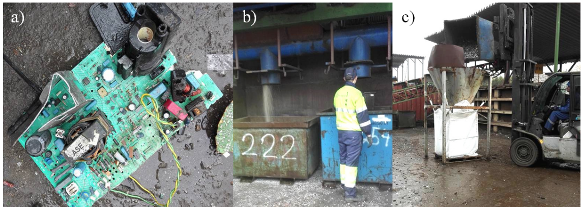
Kuva 2: a) Kierrätysprosessin syöte ennen murskausta, b) partikkelien näytteenottoa seulalla, c) näytteiden siirto BigBag-säkkiin
