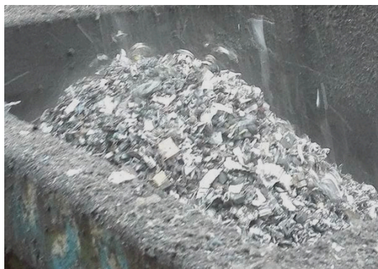
Kuva 12: Magneettisella separaattorilla separoituja partikkeleja
