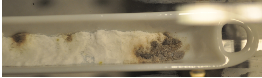
Kuva 5.11: Käytettäessä keraamista laivaa lyijy(II)kloridinäytteen asettamiseen näytetilaan, huomattiin näytteen reagoivan joksikin toiseksi yhdisteeksi. Tämä pystyttiin havaitsemaan näytteen värin muutoksesta.
