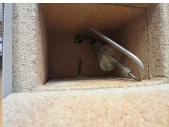
Kuva 13. Patruunan asennus uuniin.
