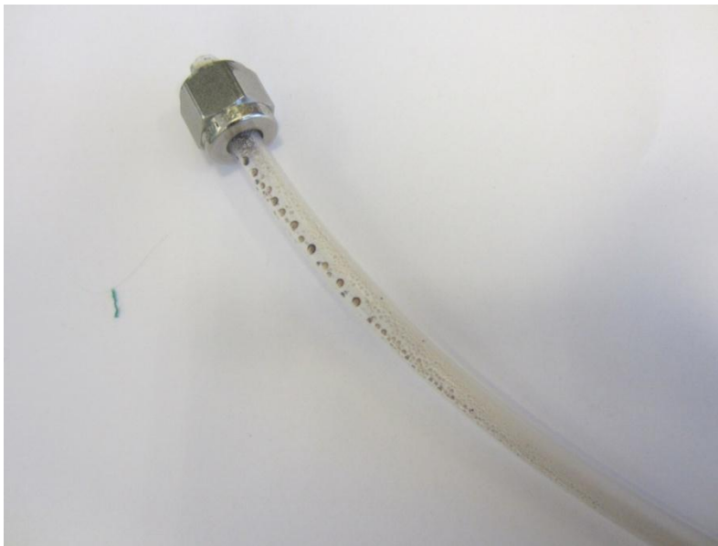
Kuva 18. Platinakoe 3. Kondensoituneita pisaroita FTIR-analysaattorin poistoletkussa.
