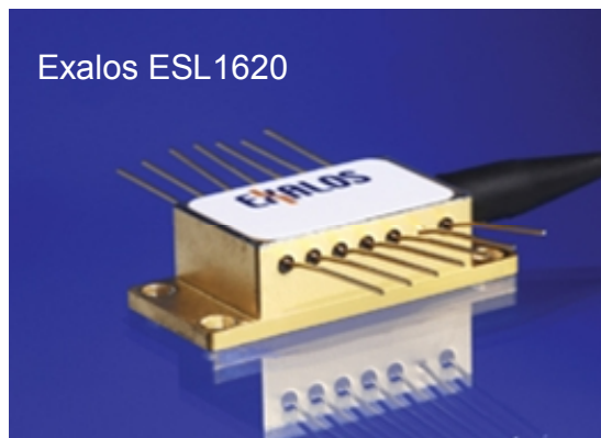
Kuva 21. Kuitukytketty Exalos ESL1620 superluminesenssidiodi butterfly-pakkauksessa ( www.exalos.com ). Valonlähde koostuu diodimoduulin lisäksi butterfly-alustasta sekä virta- ja lämpötila-ajureista.
