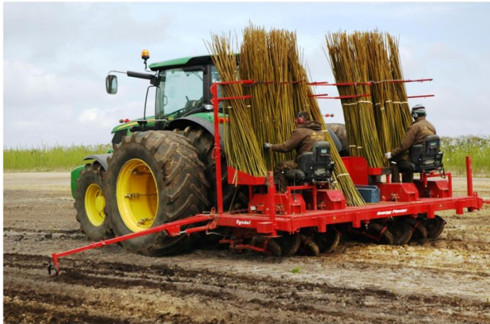
Kuva 26. Pajun istutusta Tanskassa 4-rivisellä Egedal Energy Planter istutuskoneella. Kuva Ny Vraa bioenergy.
