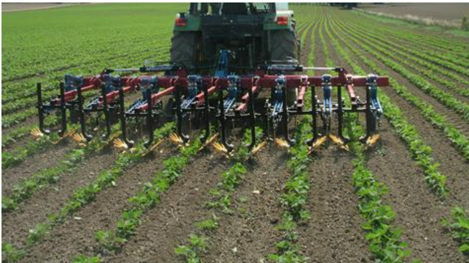
Kuva 11. Sormikiekkoharoilla rikkakasvien poisto onnistuu myös riviltä. Rivien välistä rikkakasvit torjutaan samalla ajokerralla hanhenjalkavantaila tai S-piikillä. Kuva Hatzenbichler.
