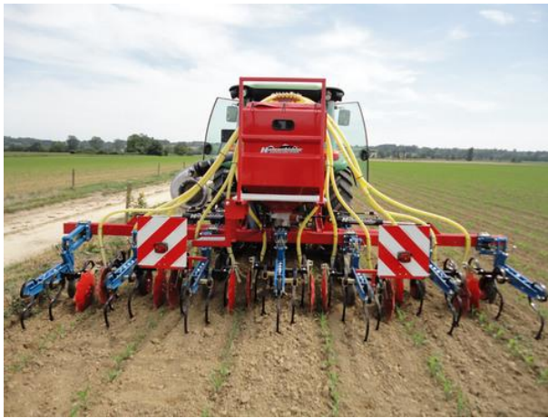
Kuva 22. Maissin lannoitus voidaan tehdä harauksen yhteydessä. Kuva Hatzonbichler
