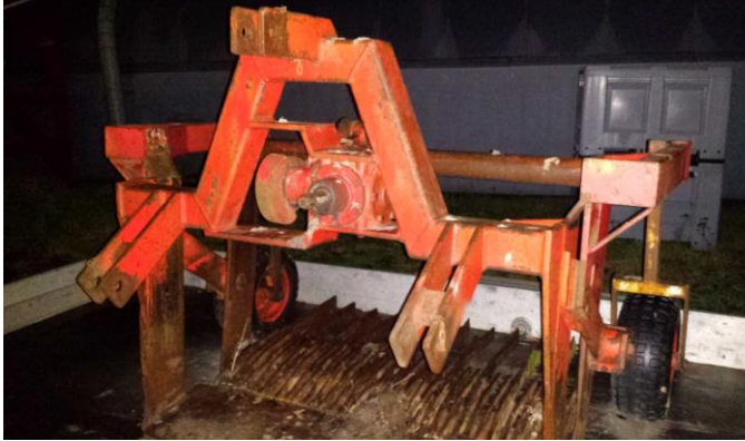
Kuva 1. Taimien nostoon käytetty kone, joka ravistaa multaa pois juurista
