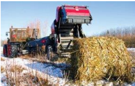
Kuva 29. Pajun korjuu onnistuu myös vankkarakenteisella WB-55 BioBaler harvesteri paalaimella. Kuva Tony Kryzanowski.
