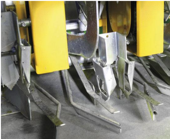
Kuva 9. Hortec koneen istutusvannas, jolla voidaan istuttaa myös katekalvon läpi taimia (Kuva Hortech Horticulture Technology)
