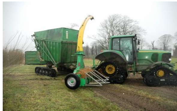
Kuva 30. Korjuukoneeseen asennetut telat parantavat kantavuutta ja vähentävät renkaiden puhkeamisriskiä. Kuva Ny Vraa bioenergy.
