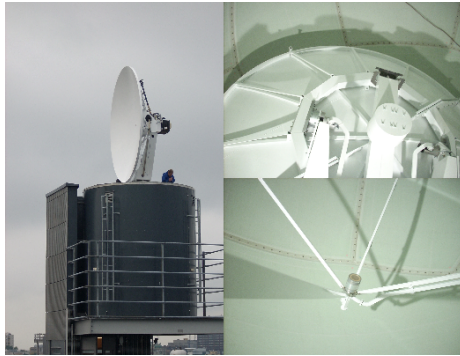
Figure 2.2: Kumpula C-band weather radar (KUM)
