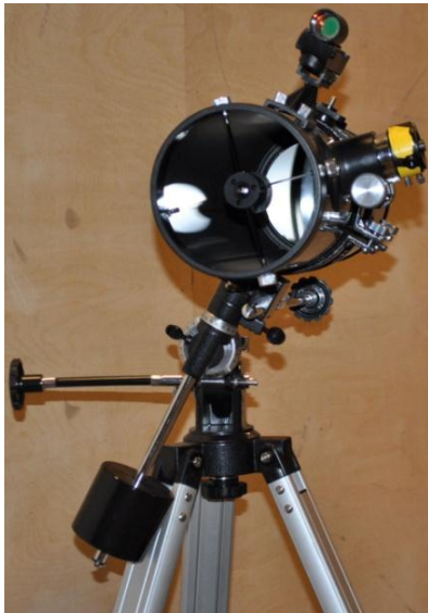
Kuva 5.10 Vasemmalla: Peilikaukoputki kuitukytkimineen. Oikealla: Linssi-optinen lähetin-vastaanotin.
