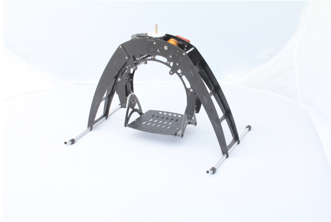
Kuva 7. UAV –helikopterin avoin kamera-alusta ja suljettu kamerakokonaisuus esim. lennokkiin [24]
