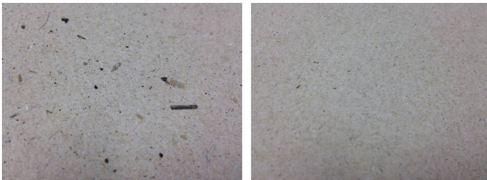
Kuva 17. Erilaisia likapartikkeleita korkeasakeuspulperoidussa näytteessä (vas.) sekä saman kuitunäytteen painelajitellussa sekä flotatoidussa akseptissa (oik.)
