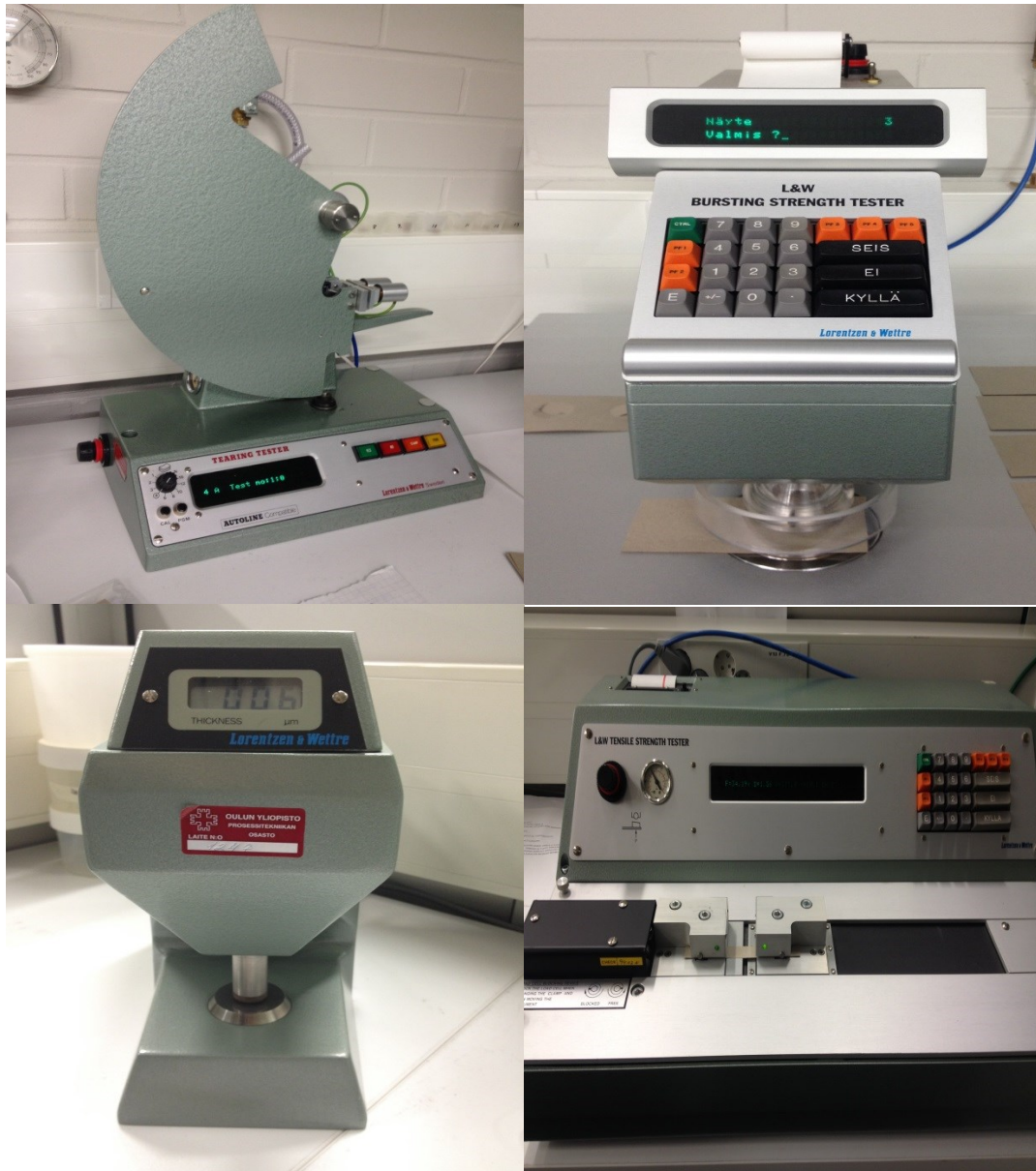
Kuva 12. L & W paperiteknisten ominaisuuksien mittaukseen käytettyjä laitteita. Repäisylujuusmittari (vas. ylh), puhkaisulujuustesteri (oik. ylh.), mikrometri eli paksuusmittari (vas. alh) sekä vetolujuusmittauslaite (oik. alh.)
