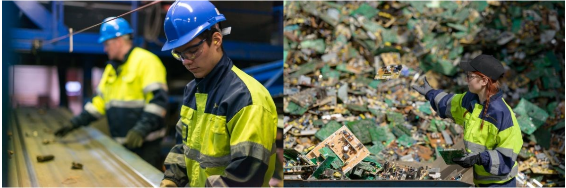
Kuva 9 Niin sähkö- ja elektroniikkaromun kuin eri piirikorttilaatujen manuaalinen erottelu mahdollistaa optimoidut kierrätysprosessit (Kuusakoski Oy)
