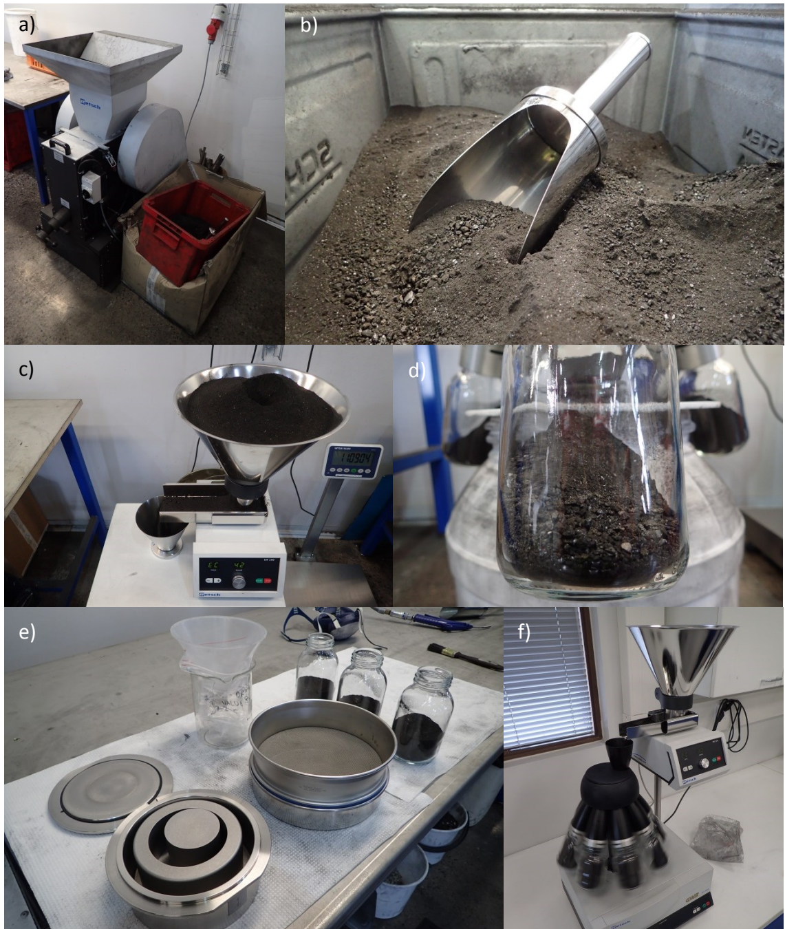
Kuva 42 a) Leukamurskain b) jauhettu näyte leukamurskaimen jälkeen c) kahtiointilaitteen syöttöastia ja -kuljetin d) Jaettu noin kilon näyte e) levymyllyllä jauhetaan kaikki partikkelit, jotka eivät läpäise 0,5 mm seula f) kasijakolaitteella jaetaan kaksi rinnakkaista noin yhden gramman näytettä
