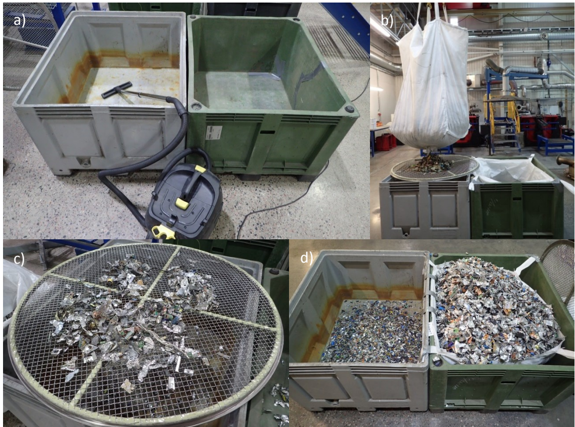
Kuva 38 a) Muovisäiliöiden puhdistaminen b) big bagien virittäminen nostimella seulaverkon yläpuolelle c) ylite seulonnan jälkeen d) lopputulos yhden näyte-erän seulomisen jälkeen
