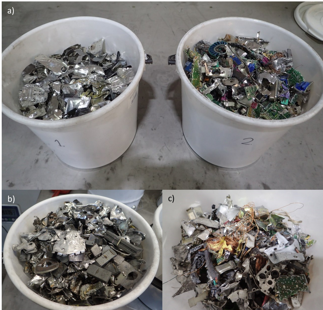
Kuva 54 Ferromagneettiseen fraktioon päätyneiden kappaleiden jakaminen puhtaisiin ja epäpuhtaisiin jakeisiin: a) HIGH-kortin jakautuminen b) lähikuva LOW-kortin puhtaasta ferromagneettisesta jakeesta c) lähikuva LOW-kortin epäpuhtaasta ferromagneettisesta jakeesta
