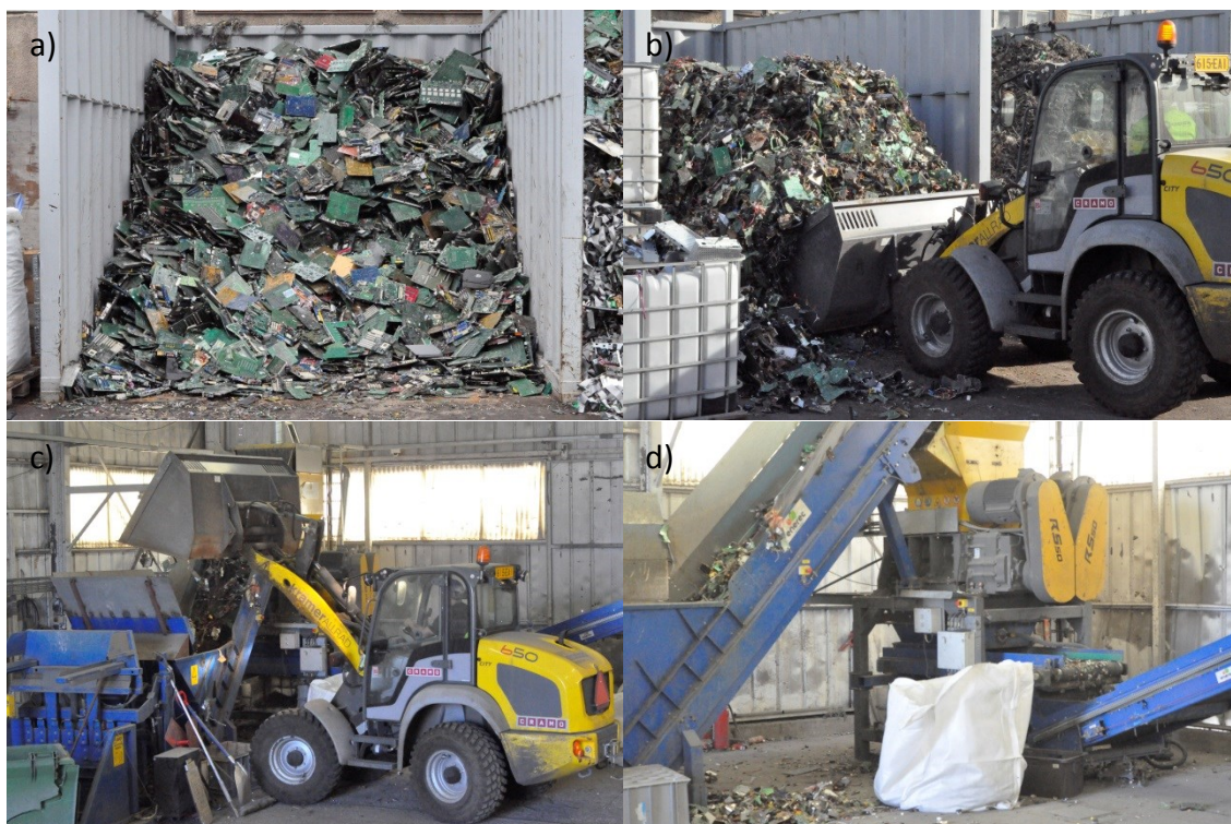
Kuva 34 a) Syöte säilytyskatoksessa, b) syötteen lastaaminen, c) syöttö kuljetushihnalle ja d) syötteen murskautuminen
