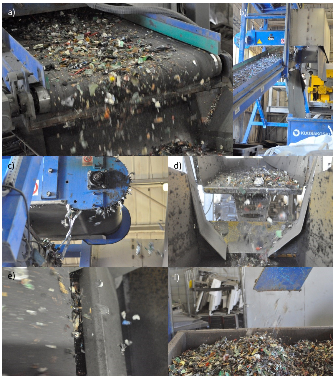
Kuva 35 a) Syöte murskauksen jälkeen b) murske kulkee kuljetushihnaa pitkin c) magneettinen erotus d) ei-ferromagneettinen fraktio jatkaa eteenpäin e) pyörrevirtaerotin ja f) pyörrevirtaerottimen droppi
