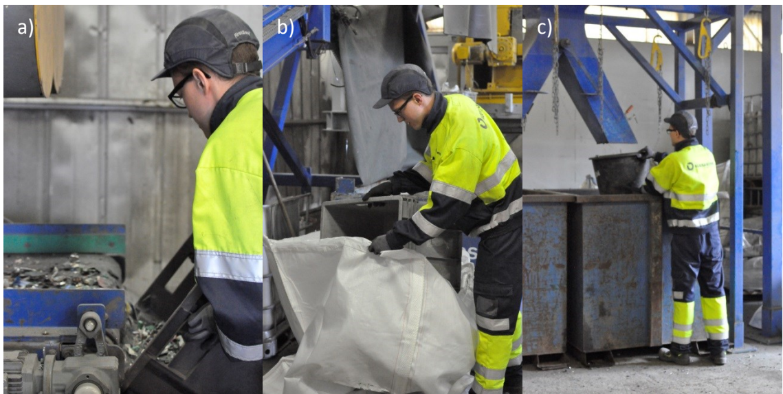
Kuva 36 a) Näytteenotto syöttestä, b) näytteenotto magneettisesta fraktiosta ja c) näytteenotto pyörrevirtaerottimen dropista
