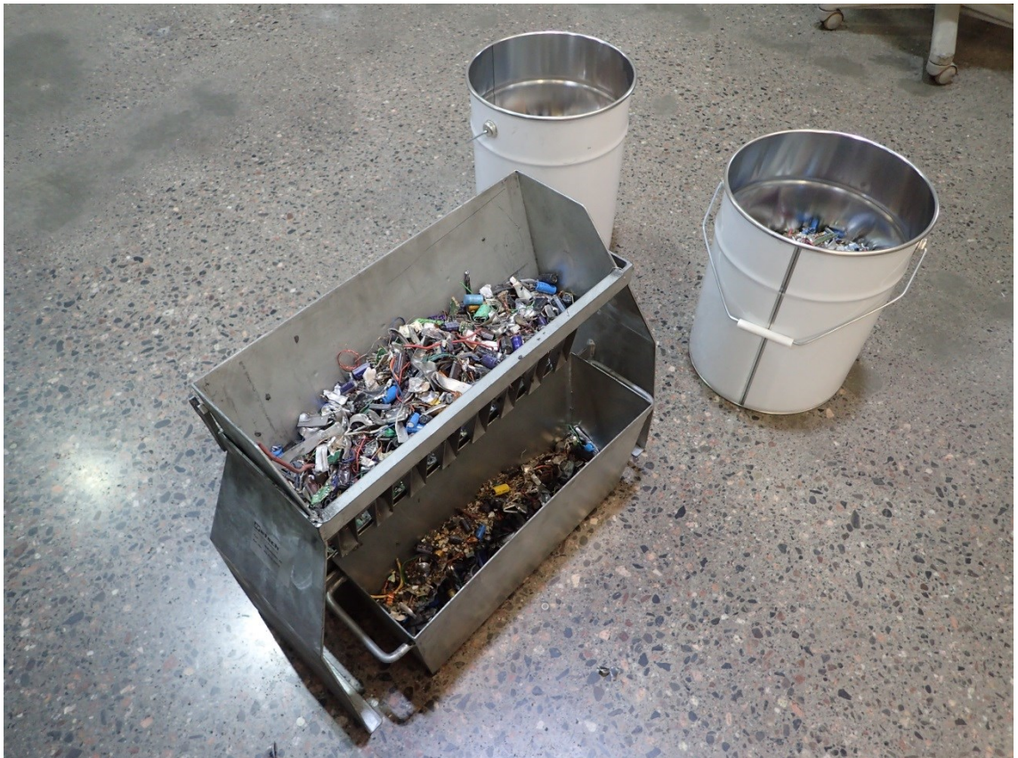
Kuva 39 Alitteen jakaminen kahteen rinnakkaisnäytteeseen jakolaitteella
