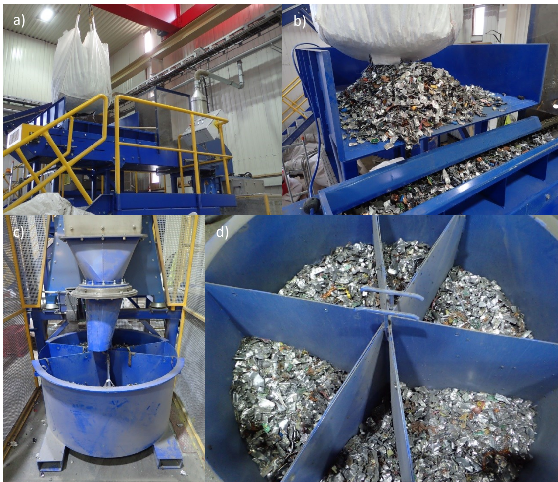
Kuva 40 a) Big bagin asettaminen nosturilla jakolaitteen syöttö-tasolle b) big bagin pohjaan puhkaistaan reikä ja syöte ohjataan kuljetinhihnalle c) jakolaitteen syöttökouru pyörii ympyrää jakolaitteastian yläpuolella d) ylite on jaettu kahdeksaan osaan, joista otetaan kaksi rinnakkaisnäytettä
