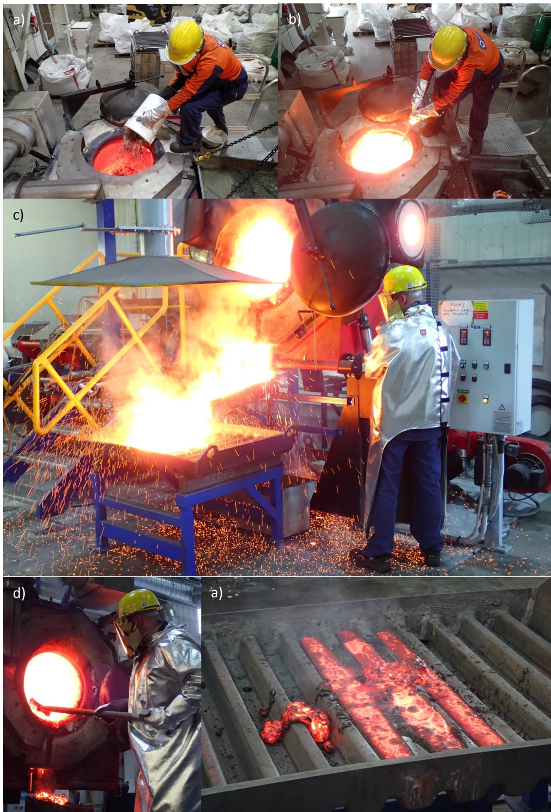
Kuva 41 a) Näyte syötetään kuumennettuun upokkaaseen b) Pyriittiseosta hämmennetään ja näytteen sulamisen tarkastelu c) Sulan pyriittiseoksen valu d) Upokkaan sisäpinnat kolataan puhtaaksi uunikolalla välittömästi alaslaskun jälkeen e) Sulaseos jätetään kokillille jäähtymään yön yli
