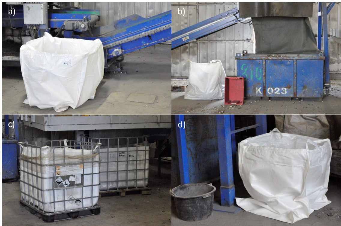
Kuva 32 a) Syötteen näytteenottopiste, b) magneettisen fraktion näytteenottopiste c) Pyörrevirtaerottimen tuotteen näytteenottopiste ja d) pyörrevirtaerottimen dropin näytteenottopiste
