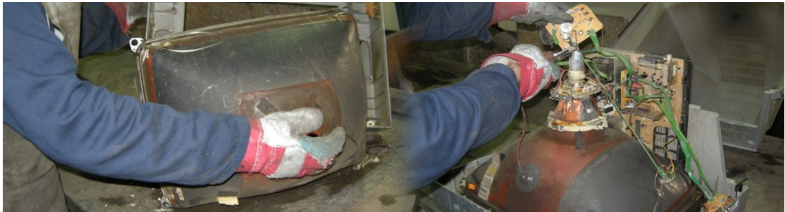
Kuva 8 Monet matala-arvoiset piirilevyt ovat peräisin kuvaputkinäytöistä (RECDEV project)
