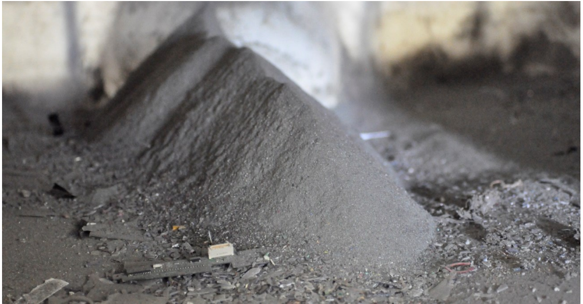
Kuva 31 Pyöröleikkurin pohjalle kertyvä pulverimainen kasa
