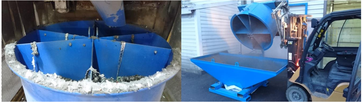
Kuva 43. Bimatec-jakolaitteen tarkkuus ei ole 100% - osa materiaalista päätyy astian ulkopuolelle, kuten vasen kuva antaa ymmärtää. Oikealla näkyy pölypilvi, joka syntyy, kun jakolaitteen astian sisältö kipataan pussituskaualoon ylimääräistä näytemateriaalia varastoitaessa. Molemmat ovat virhelähteitä, tosin kokonaisuuteen nähden vähäisiä merkitykseltään.
