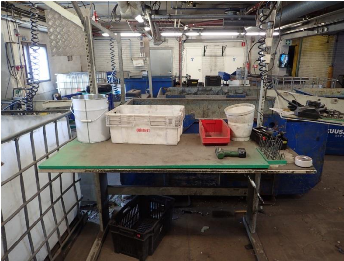
Kuva 10. Käsinalpurkajan työasema: valikoima sopivia käsityökaluja, akkuväännin kärkisarjoineen ja työaseman ympärillä keräysastioita purussa syntyville jakeille.
