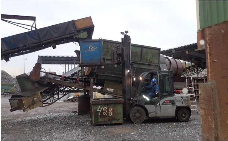
Kuva 30. Näytteenottoa trukin avulla korkealla sijaitsevan kuljettimen päästä.
