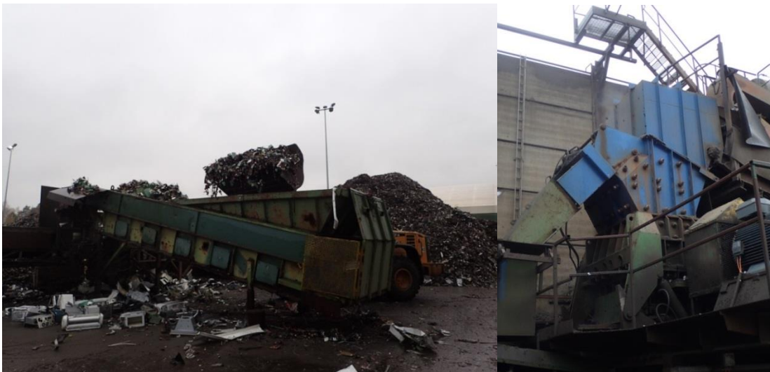
Kuvat 17 ja 18. Vasemmalla materiaalin syöttö pyöräkuormaajalla prosessin alkupäästä, oikealla rengasmurskain.
