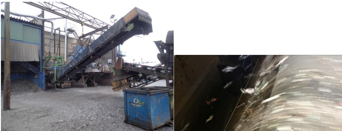
Kuvat 21 ja 22. Vasemmalla rumpumagneetilta lähtevä rautapitoinen virta. Oikealla kuva pyörrevirtaerottimen kuljettimen päästä, missä näkyy myös ohuena vaaleana viivana erotuslevyn reuna.
