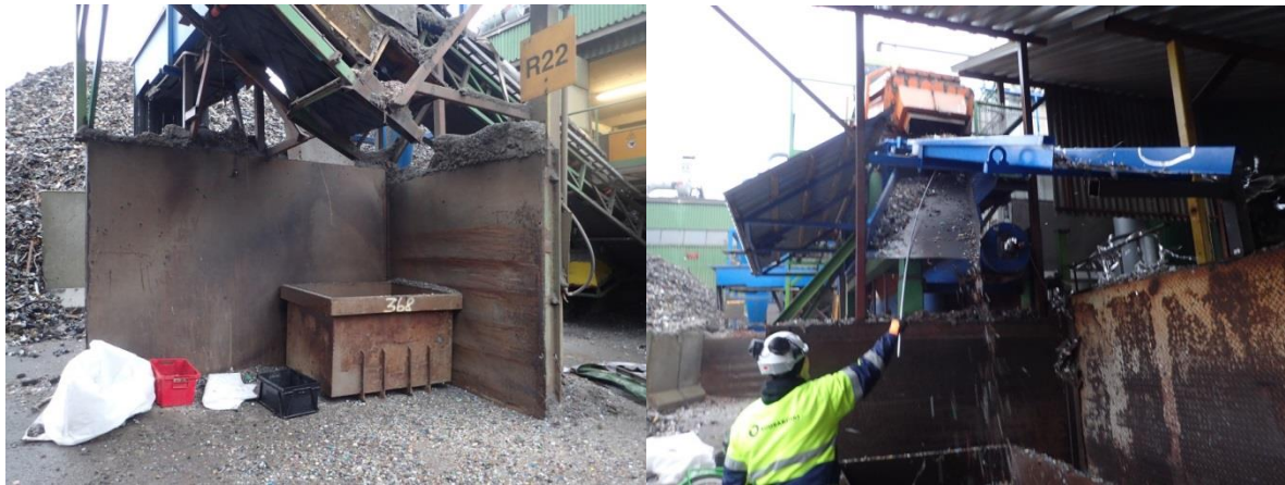
Kuvat 23 ja 24. Vasemmalla HD-magneetin luona sijaitseva materiaalin ulostulopaikka näytteenottovälineineen. Oikealla kuvan yläreunassa oranssi Trisomat-seula, joka jakaa materiaalivirran yli ja alle 15mm kokoluokkiin.
