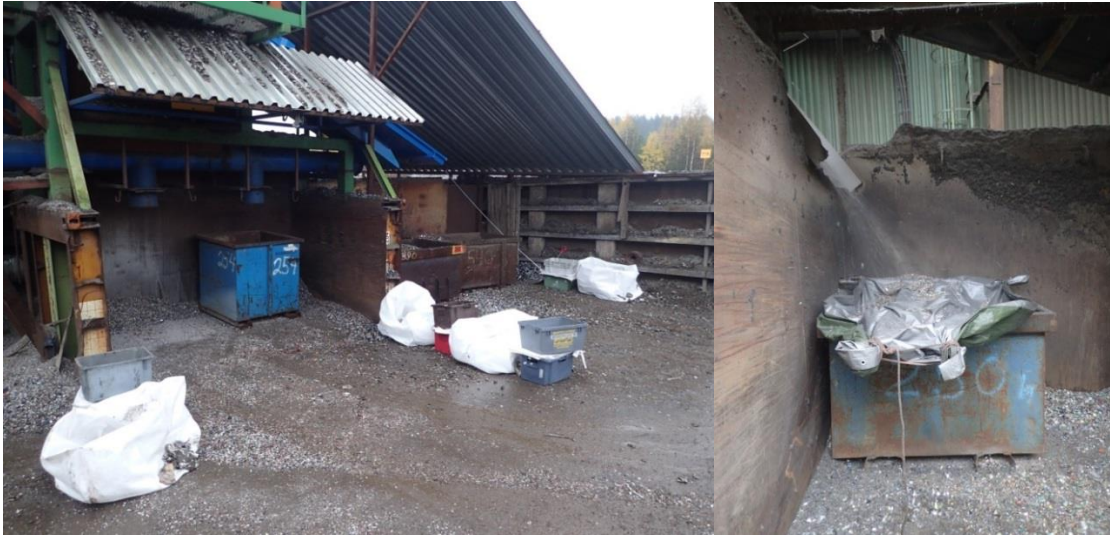
Kuvat 27 ja 28. Vasemmalla näytteenottovälineet Trisomat-seulan luona. Oikealla näytteenotossa käytetty keruuväline kohteisiin, joissa muuttolaatikon leveys ei riittänyt koko materiaalivirran keräämiseen.
