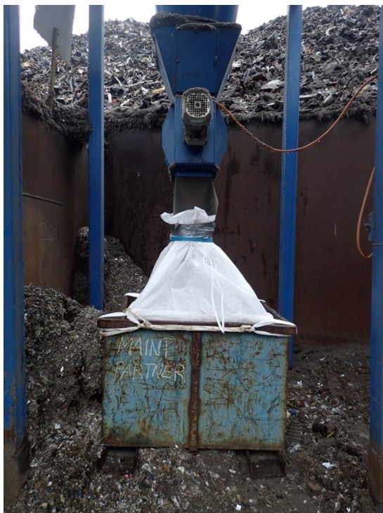
Kuva 32. Pölyjen keräys näytesäkkiin. Pölyjen kohdalla näytteenoton tarkkuus oli korkea, sillä kaikki pöly kerättiin ja keräystapakin aiheutti hyvin vähän virhettä.
