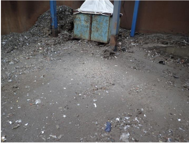
Kuva 33. Prosessi sijaitsee ulkona, joten mm. tuuli aiheuttaa oman virheensä tuloksiin. Kuvassa pieni osa hihnakuljettimilta lentänyttä pölyä, piirikortin paloja ja muita kevyitä partikkeleita.
