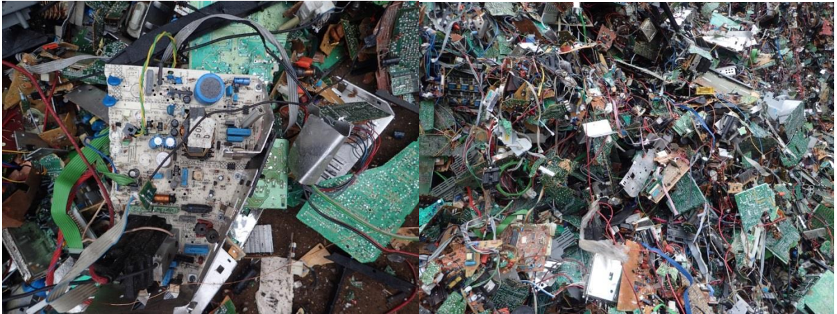
Kuvat 25 ja 26. Koemateriaalin heterogeenisyys vaikuttaa koetulosten arviointiin – kuvissa koeajomateriaaliksi tarkoitettujen CRT-piirikorttien lisäksi mm. ylimääräisiä metallisia komponentteja, muovikuoria ja muualta kuin kuvaputkinäytöistä peräisin olevia piirikortteja.
