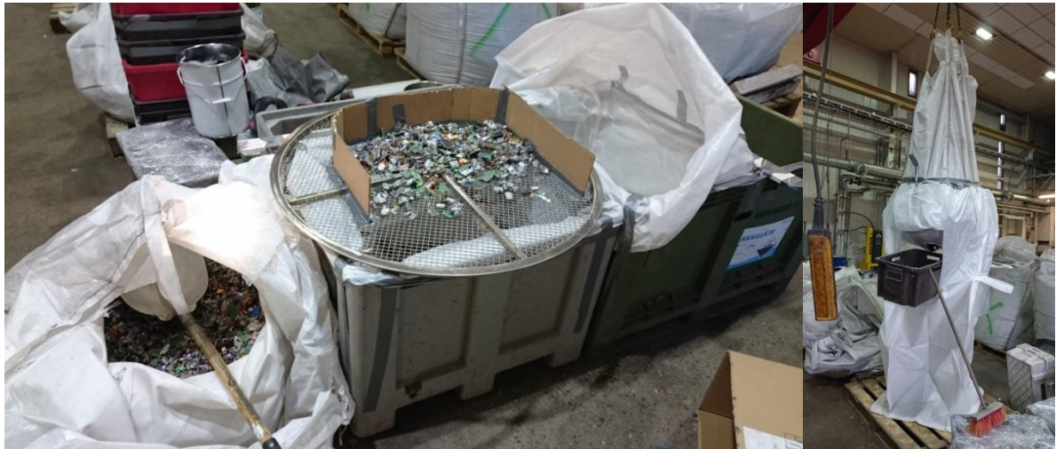
Kuvat 35 ja 36. Vasemmalla seulonta yli ja alle 15mm jakeisiin. Oikealla pienen pölynäytteen ottaminen suuresta pölymäärästä.
