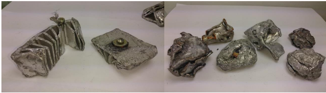
Kuvat 52 ja 53. Alumiiniset jäähdytyslementit sekä niihin kiinnittyneet ruuvit (vasen) sekä murskauksen tuloksena kokoon puristuneet, erilaisia komponentteja sisäänsä sulkeneet teräksiset ja alumiiniset pellinpalat.
