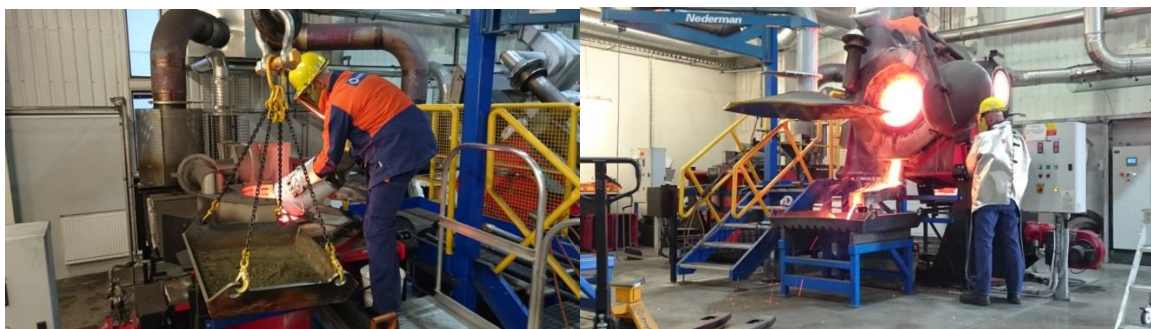
Kuvat 39 ja 40. Sulatusnäytteen panostus (vasen) ja sulatetun, pyriitillä seostetun näytteen valu.
