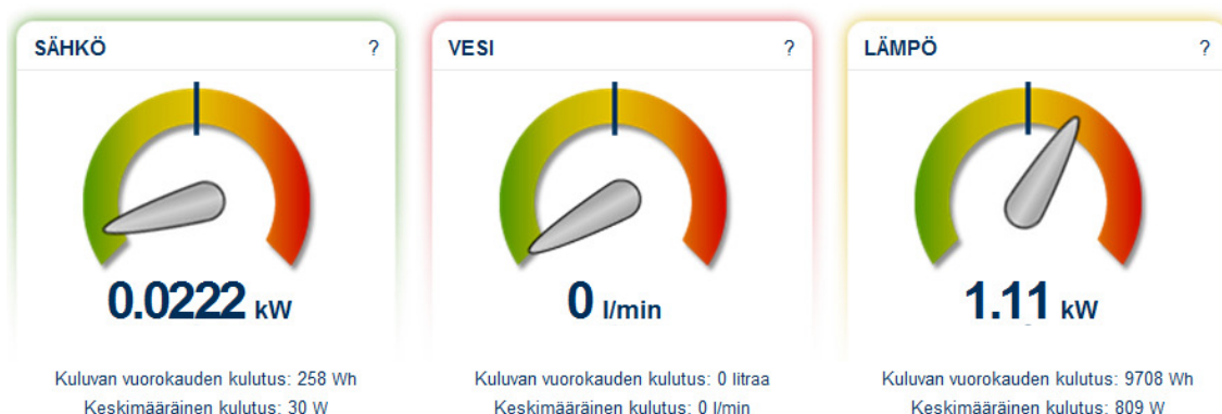
Kuva 6.1 Nopeusmittarit kertovat hetkellisen kulutuksen. Nopeusmittarit esitetään sekä huoneistonäytössä että web-sivuston asukasportaalissa.
