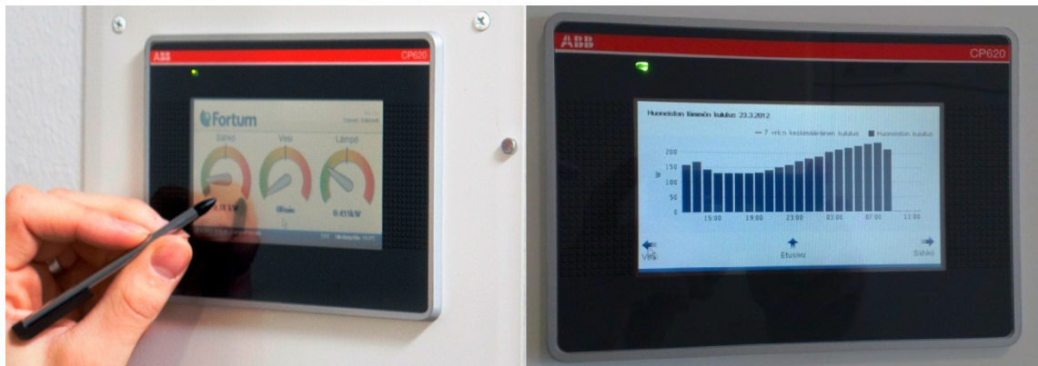
Kuva 6.3 Huoneiston seinälle asennettu huoneistonäyttö. Huoneistonäytöstä nähdään vain reaaliaikainen nopeusmittareilla kuvattu kulutus (vasen kuva) sekä diagrammeina viimeisen seitsemän vuorokauden kulutus (oikea kuva). Oikeanpuoleisessa kuvassa nähdään yksityiskohtaisempi kulutus. (Kuva vasemmalla: Skanska; kuva oikealla: Vesa Pietilä)
