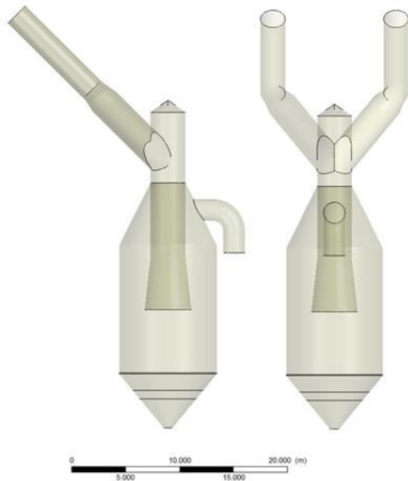
Kuva 17. Masuunin pölysäkin läpileikkaus. (Paananen et al. 2011)
