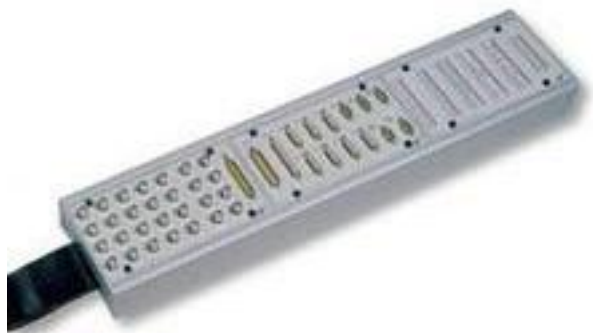
Kuva 6.8. dSPACE-järjestelmän CP1103-liitäntäpaneeli (Hemminki 2005)
