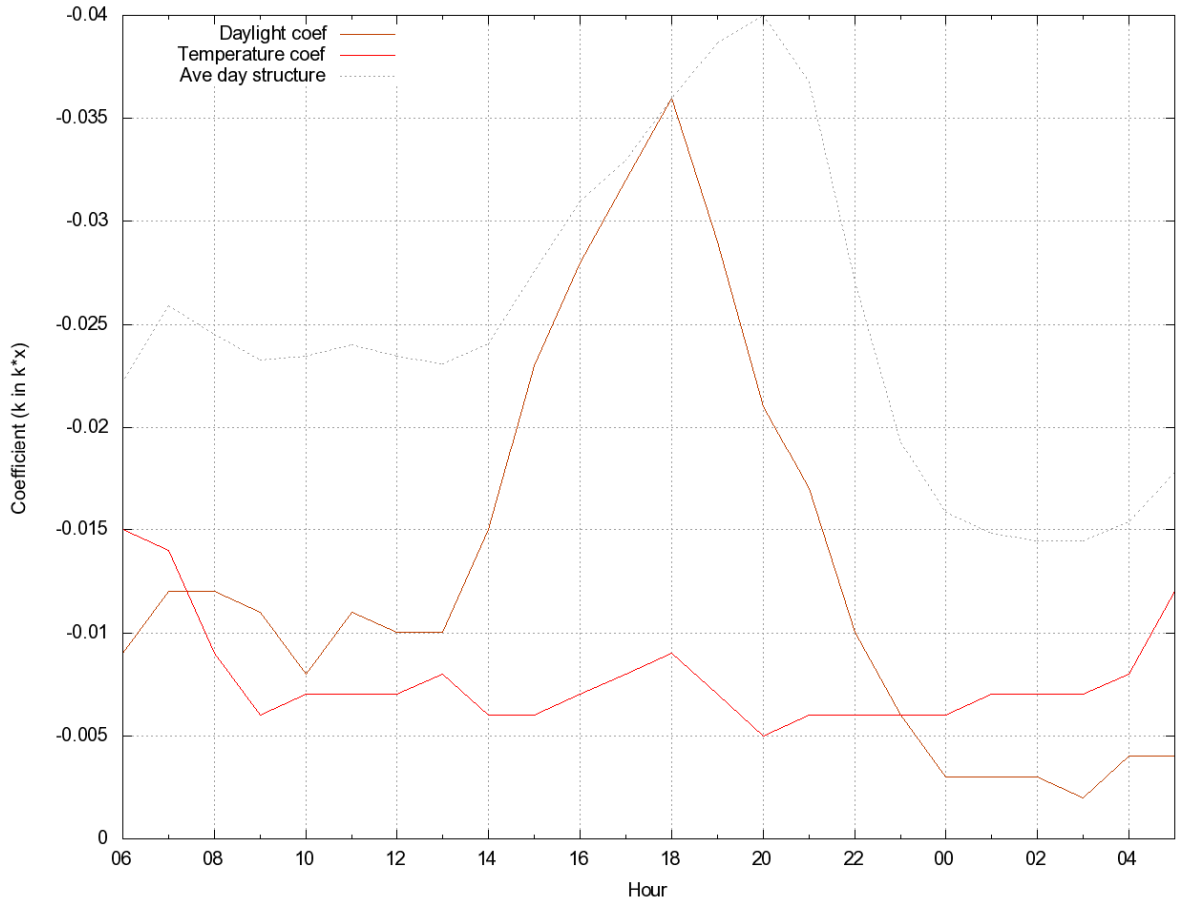
Kuva 16: Keskimääräisen öljylämmittäjän regressionsovituksen antamat kertoimet arkipäivänä, kun päivän keskiarvolämpötila on alle +8 astetta. Oranssi ja punainen käyrä kuvaavat kertoimia b_1 ja b_2 kaavassa 5.11 eri kellonaikoina. Oranssi kuvaa valoisuuden vaikutusta ja punainen lämpötilan vaikutusta. Esim. klo. 18 valoisuuden selittävä vaikutus sähkönkulutukseen on suurimmillaan. Tässä esitettyjen kertoimien mukainen päivä rakenne nähdään kuvassa 15.
