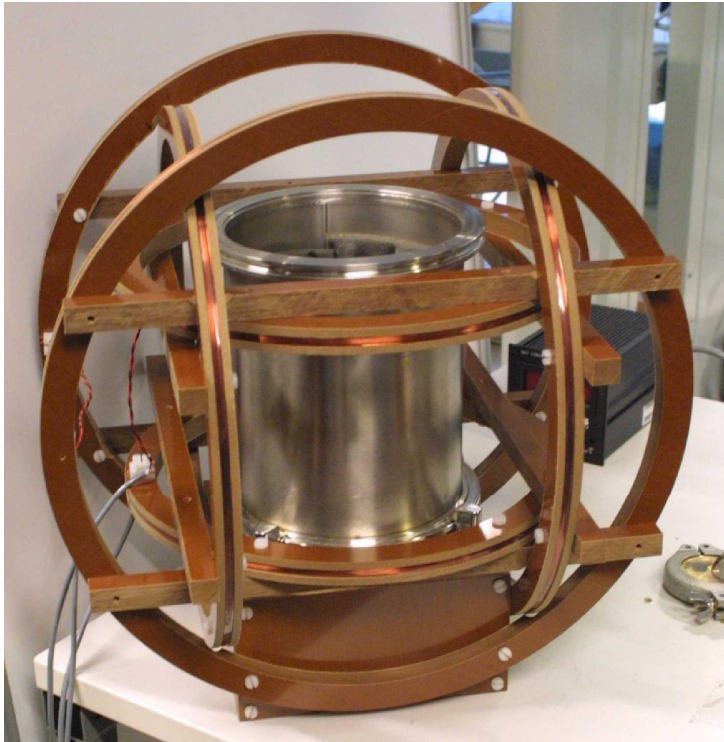
Kuva 19. Helmholtzin kela. Rakennelman keskiosaan saadaan muodostettua kohtuullisen homogeeninen magneettikenttä johtamalla virtaa rakennelman ulkopinnoilla kulkeviin keloihin. Kentän suunta voidaan valita kolmiulotteisesti.
