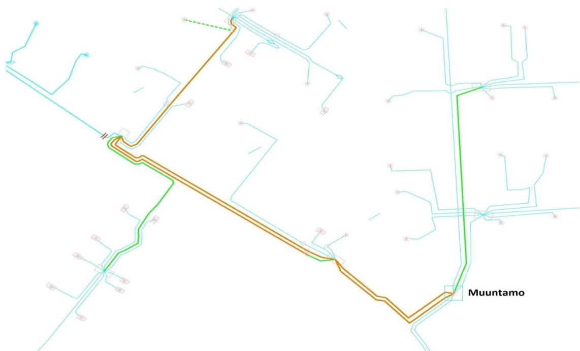
Kuva 33: Tarkastellun muuntopiirin kaapeleiden kuormitus, kun kuorman ohjaus on optimoitu yösähkön osalta. Turkoosi kuvaa peruskuormitusta, vihreä yli 30 % ja ruskea yli 80 % kuormitusastetta.
